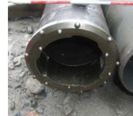
リングビット取付状況
