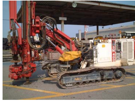
写真-1.3.4 削孔機械 SM400
