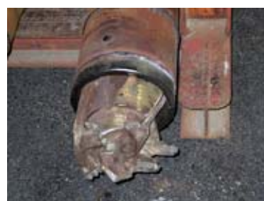
写真-2.3.2 回転式削孔方式
