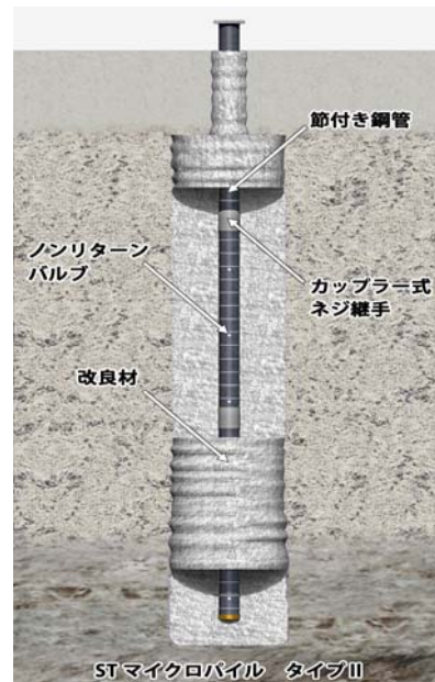
図-2.1.1 ST マイクロパイル工法タイプII概要図
