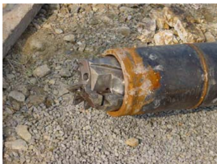
写真-2.3.9 切削扩径ビット (二重管削孔ツール)
