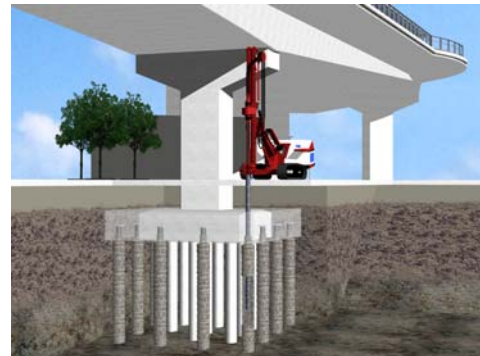
写真-2.3.8 既设构造物基础の补强
